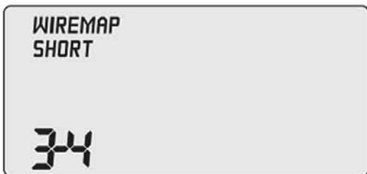
Если в кабеле или в подключенном разъеме имеется короткое замыкание, то на ЖК-дисплее передатчика будет показана надпись «3–4» и раздадутся три коротких звуковых сигнала.
