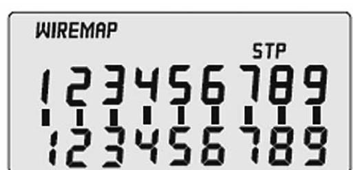
Если кабель RJ-45 имеет экранную оплетку, то на экран будет выведен дополнительный номер провода — 9.
