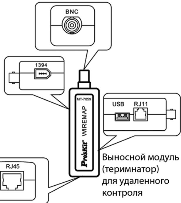
Выносной модуль (терминатор) для удаленного контроля
